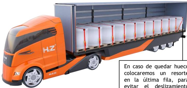
En caso de quedar hueco colocaremos un resorte en la última fila, para evitar el deslizamiento longitudinal
