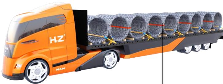
Para unificar rollos, usaremos cintas de una pieza cuya LC equivalga en daN a los kg que suman los rollos unificados.
