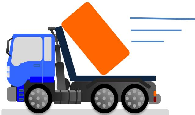
El vuelco hacia delante suele producirse como consecuencia de una fuerza G elevada, que puede ser de hasta 0,8G, unido a una fijación insuficiente y una altura importante en relación al ancho de la carga.
