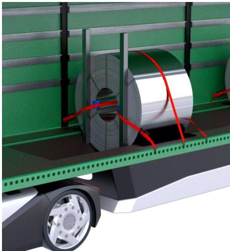
**Conclusión:** Entendemos como técnica del bloqueo computable, a aquella que pueda verificarse a través de **una fuerza de bloqueo homologada y demostrable** mediante certificados o marcas, a fin de que el agente o el usuario puedan realizar el cálculo correspondiente.
