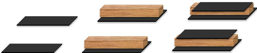
El antideslizante hay que colocarlo debajo de los pallets y debajo y encima de los listones, si las cargas no van unificadas al listón
