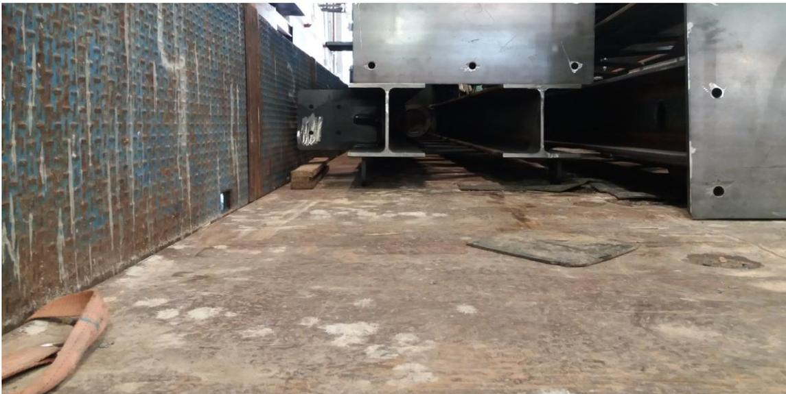
Ejemplo: camión con suelo muy abollado que pone en peligro la estabilidad de la carga
