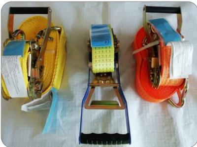
Son los dispositivos de sujeción más utilizados. Constan de una o dos piezas, dotadas de una cinta de tejido plano y un dispositivo tensor o para la retención de la tensión. Al generar tensión, la cinta se tensa y produce la fuerza o resistencia necesaria como para sujetar la carga.
