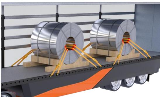
No es aconsejable el transporte sobre pallets, ya que aunque técnicamente esté permitido si se aplicase la fuerza requerida, en la práctica suele haber embalaje no adecuado, ausencia de puntos de amarre o equipos adecuados para la fijación y, sobre todo, un centro de gravedad muy elevado que favorece el vuelco de la bobina e incluso del vehículo.
