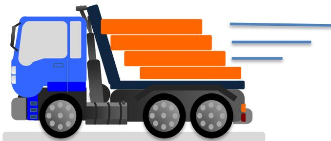
Varias cargas se deslizan hacia delante pudiendo hacer diversos efectos abanico / dominó, por la diferencia en el coeficiente de rozamiento y fuerzas a que se ve sometida cada capa o pieza.
