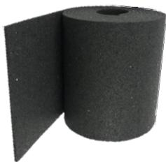
Cuando el coeficiente de rozamiento sea inferior a 0,45 (por ejemplo cuando el suelo del vehículo es de chapa, o la superficie de la carga es plástico, metal o PVC) es siempre aconsejable el uso de antideslizante. Lo contrario no sería operativo debido al gran número de trincas requeridas acorde a la normativa técnica.
