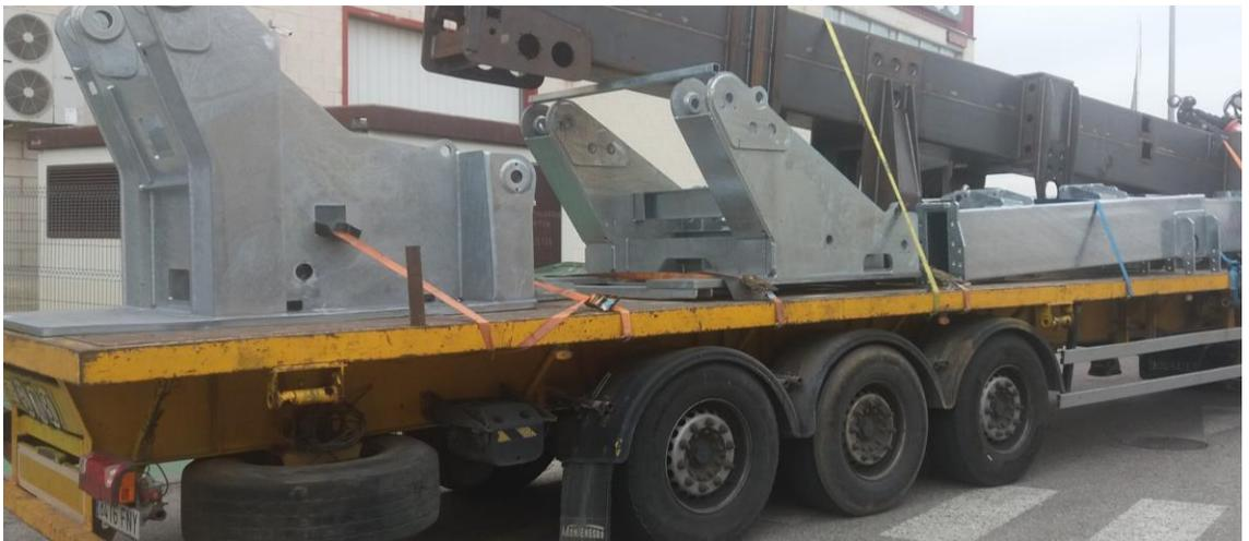
También pueden utilizarse las partes estructurales de un remolque con plataforma baja para fijar los ganchos de una cadena. Además, se pueden usar otros puntos de anclaje **de acuerdo con las instrucciones del fabricante** y conforme a las cargas certificadas que pueden resistir.
