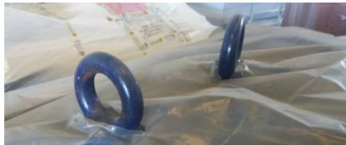
*Un ejemplo pueden ser los cáncamos fijos, que sólo pueden usarse para elevación recta y a veces se usan para fijar la carga, con grave peligro.*
