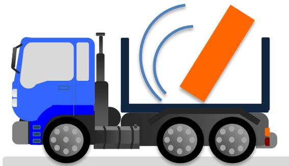
El vuelco hacia atrás se produce por una inclinación de la carretera o una aceleración brusca, en combinación con una fijación insuficiente. El impacto del vuelco puede dañar gravemente partes del vehículo y producir la pérdida de la dirección, con el consiguiente riesgo de accidente.
