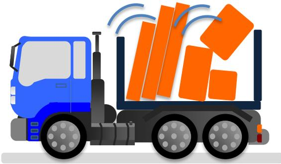
El vuelco de carga no compacta hacia atrás puede tener formas muy diversas. En general se produce por diferente altura, espacios abiertos y sujeción insuficiente. Es típico de los camiones que van cargados a menos de  $\frac{3}{4}$  partes de su longitud interna.
