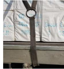
**Subpunto 20.3.3.b Dispositivos de retención de carga muy deteriorados y que no son ya apropiados para el uso.**
