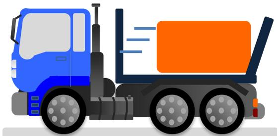
La fuerza con que una carga puede deslizarse hacia atrás en una aceleración brusca o una inclinación de la carretera puede llegar a ser de hasta 0,5G. La carga puede llegar a romper las paredes traseras.
